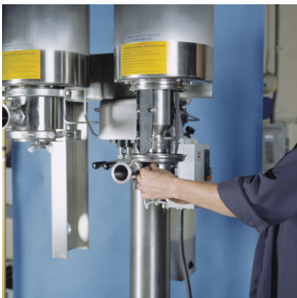
Подъёмный гидравлический механизм
