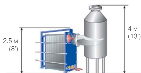
AlfaVar по сравнению с кожухотрубной выпарной колонной.
